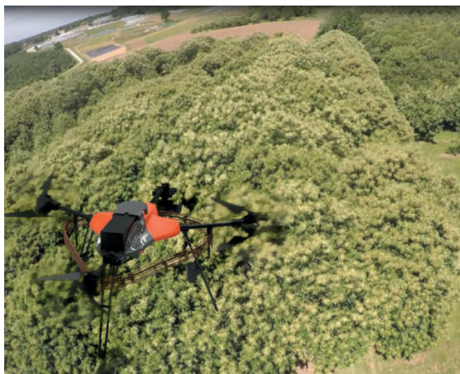
Mise en place de la confusion sexuelle à l'aide d'un drone
